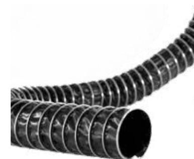
Tubo flessibile realizzato con tessuto in poliestere spalmato di Viton con spirale esterna in filo di acciaio zincato. Buona resistenza agli agenti chimici, ai raggi UV e all'ozono. Elevata resistenza agli strappi e alle vibrazioni
