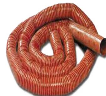
Tubo flessibile realizzato con uno strato di tessuto in fibra di vetro spalmato di silicone autoestinguente, spirale interna e visibile in acciaio armonico ramato, cordoncino esterno in fibra
