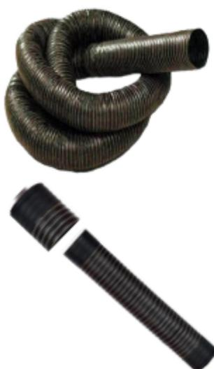
Tubo flessibile realizzato con uno strato di tessuto in fibra di vetro spalmato di neoprene, spirale interna e visibile in acciaio armonico ramato, cordoncino esterno in fibra di vetro.
